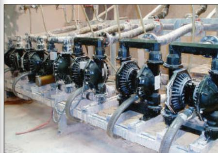
3" Membranpumpe eingesetzt zur Förderung von Schlacke in einer Keramikproduktion.
